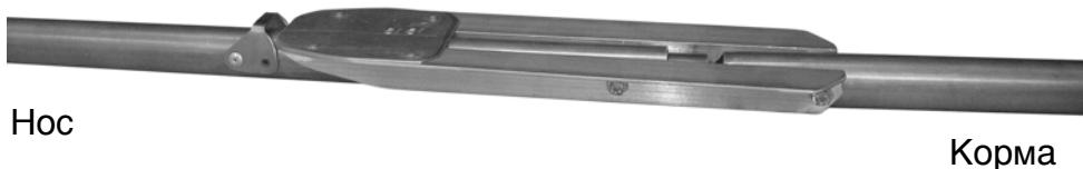
Рис.8. Установка кильсона.
