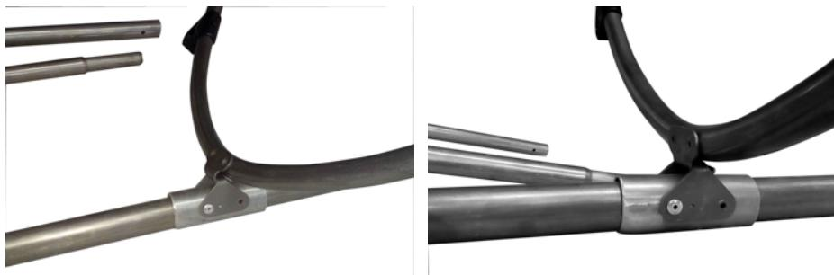
Рис.2. Установка шпангоута на штевень или кильсон.
