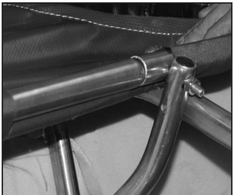
Рис.16. Закрепление фальшбортов.
