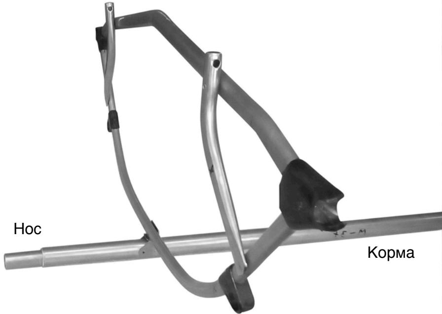
Рис.7. Установка шпангоута №3.
