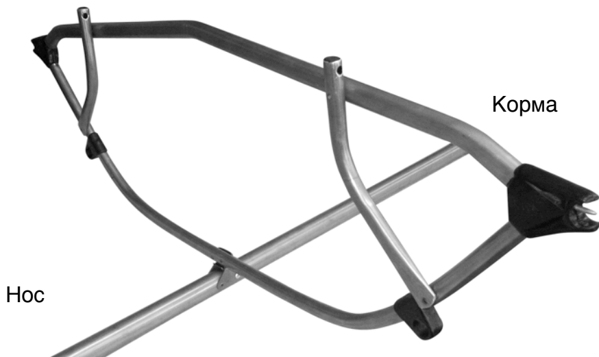
Рис.14. Установка шпангоута М.
