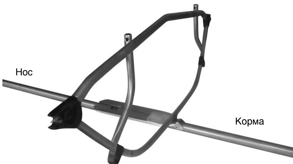
Рис.8. Установка шпангоута 2 над замком кильсона.
