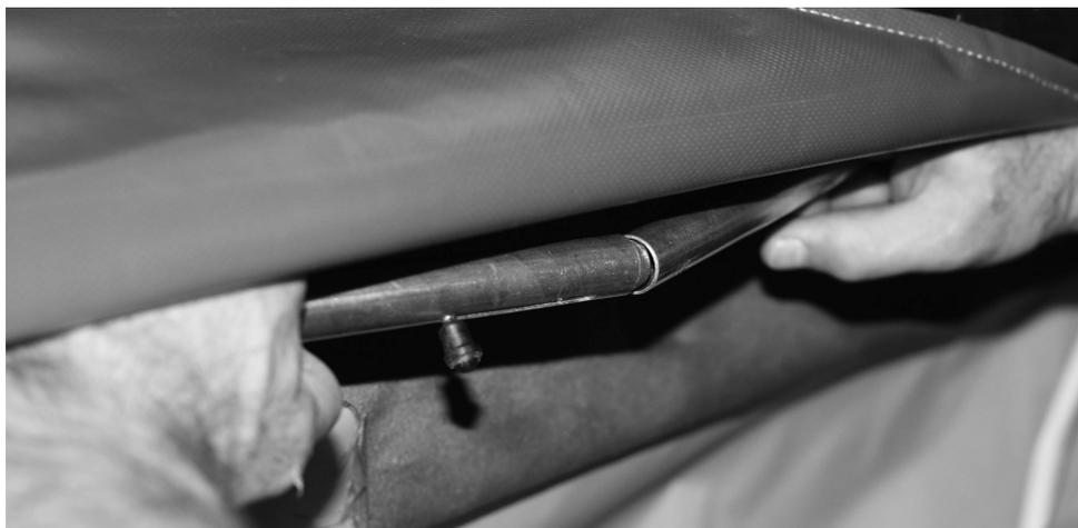
Рис.9. Соединение привальников.
