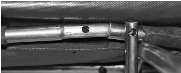
Рис.14. Соединение фальшбортов.
